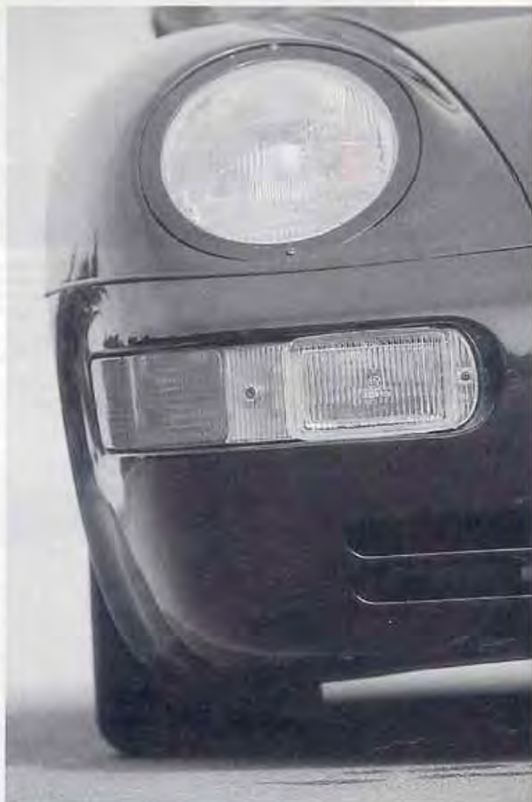
Oben: Aerodynamische Frontpartie wie der 959, mit flachen Scheinwerfern und GFK-Kotflügeln. Rechts: Rennatmosphäre im Innenraum mit Hosenträger-Gurten und lederbezogenen Kohlefaser-Sitzen. Links und unten: Bei genauerem Hinsehen entdeckt man ein gewaltig breites Hinterteil mit GFK-Verbreiterungen und einem kräftig brüllenden Doppelauspuff
