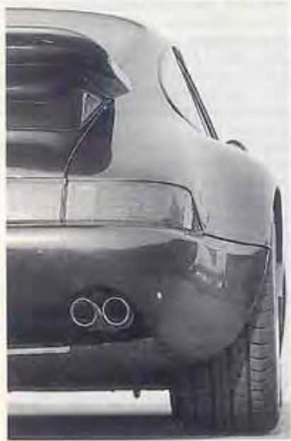
Oben: Aerodynamische Frontpartie wie der 959, mit flachen Scheinwerfern und GFK-Kotflügeln. Rechts: Rennatmosphäre im Innenraum mit Hosenträger-Gurten und lederbezogenen Kohlefaser-Sitzen. Links und unten: Bei genauerem Hinsehen entdeckt man ein gewaltig breites Hinterteil mit GFK-Verbreiterungen und einem kräftig brüllenden Doppelauspuff
