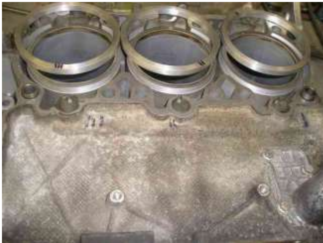
Bild 43: Unsere Verstärkungsringe, sichtbar und lose liegend am oberen Ende der Zylinder vor der Montage. Später befinden sich die Ringe direkt unter der Kopfdichtung und erzeugen einen Closed-Deck Motor.
