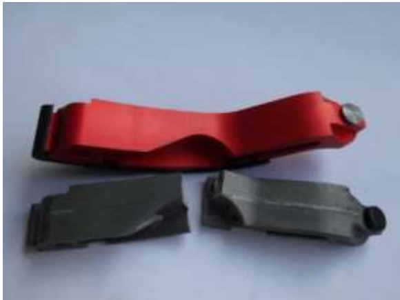
Bild 26: Gebrochene originale Kettenschiene (unten) sowie verstärkte Cartronic/Hartech Version (oben)
