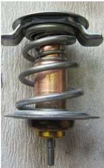
Bild 18: Das neue Niedrigtemperatur-Thermostat tut dem Motor gut
