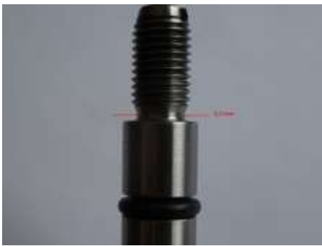
Bild 36: Zu schwach ausgelegter 10 mm Serien-Spannbolzen aller Zwischenwellenlager von 1996-2006 / Gewinde M8
