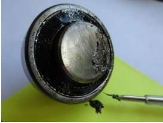
Bild 34 und 35: Defektes 996 Zwischenwellenlager mit Spänen (links - nach Ausbau, rechts - entfernter Deckel mit erkennbaren Metallflitter aus dem Inneren des Lagers)
