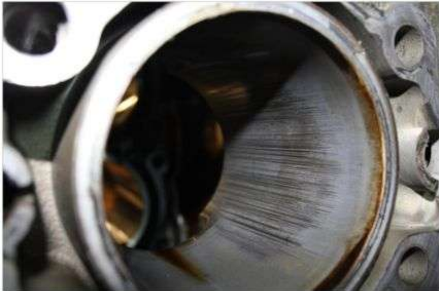
Bild 1: Zylinderlaufbahn mit typischen Fressspuren
