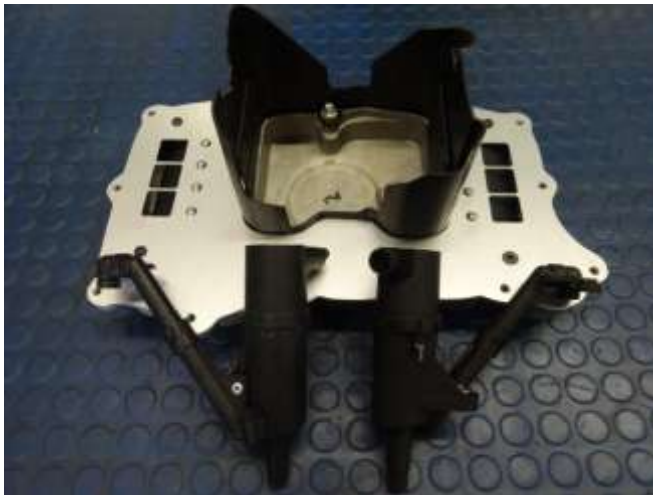
Bild 52: Die Hartech/Cartronic Racing-Ölwanne mit einem ausgeklügelten Ölrückhaltesystem. Im Vordergrund die beiden modifizierten Ölabscheider.
