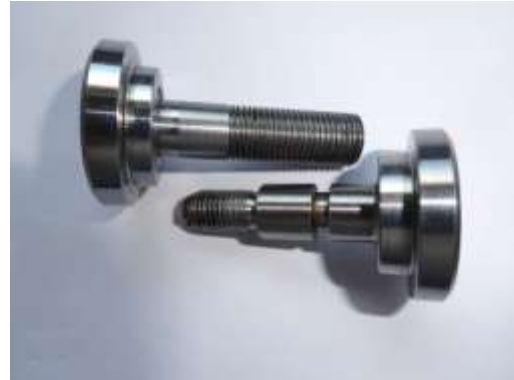
Bild 37: Verstärkte Version von Cartronic / 10mm mit Gewinde M10 vs. Serie/ 10 mm mit Gewinde M8 und 6,3 mm Materialstärke an schwächster Stelle
