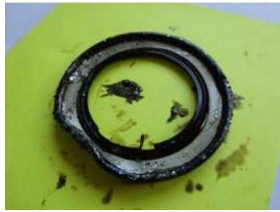
Bild 34 und 35: Defektes 996 Zwischenwellenlager mit Spänen (links - nach Ausbau, rechts - entfernter Deckel mit erkennbaren Metallflitter aus dem Inneren des Lagers)
