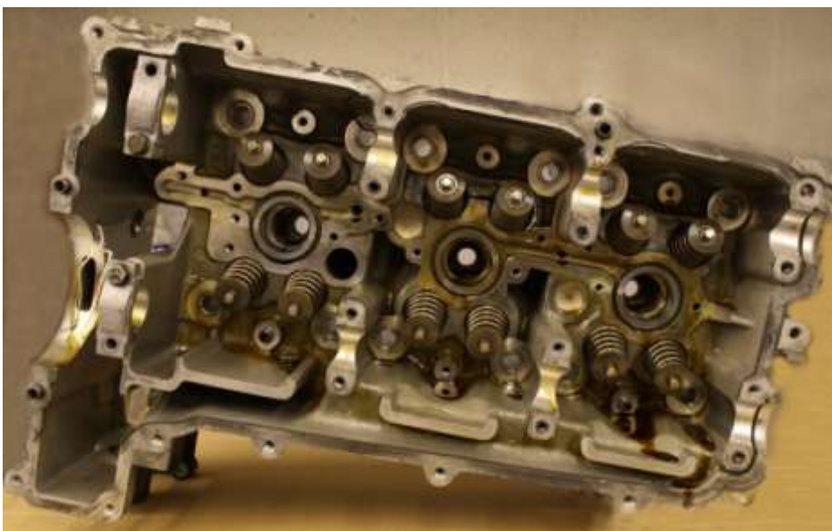
Bild 51: Zeigt die Stellung eines 986/987 Zylinderkopfes, wenn das Fahrzeug an starkem Gefälle geparkt wurde. Öl sammelt sich und kann nicht ablaufen
