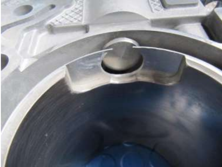
Bild 50: Eingepresster neuer Schmiede-Zylinder. Nur 1,5 mm vom originalen Zylindermaterial verbleiben zur sicheren Führung und Aufnahme des neuen Zylinders.
